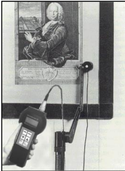
Bild 4: Museumsadapter mit Stativ für die Messung auf beliebig geeigneten Exponaten oder Raumbegrenzungsflächen
