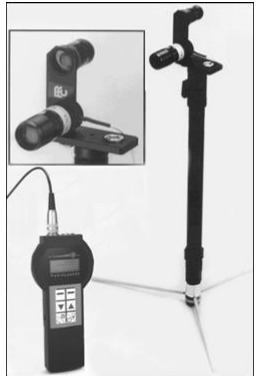
Bild 5: Leuchtdichtemessung mit Leuchtdichte-Vorsatz und Visiereinrichtung
