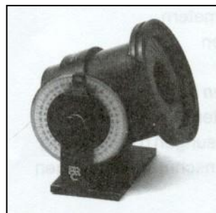
Bild 7: Tubus mit Irisblende zur Ausblendung von Streulicht
