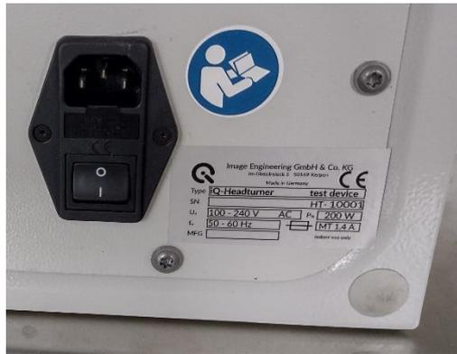
Abbildung 5 Hauptschalter und Typenschild
