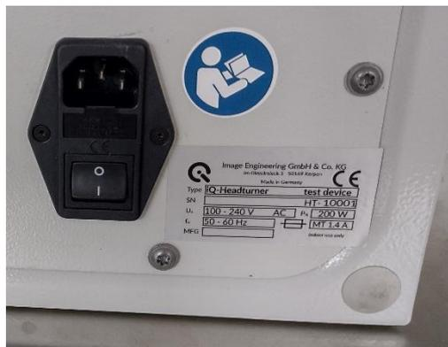
Abbildung 7 Hauptschalter und Typenschild
