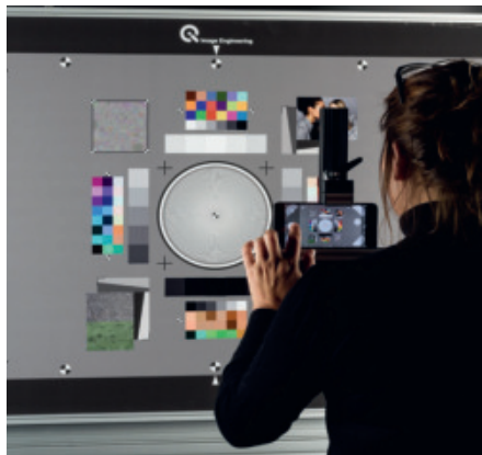
使用TE42图卡进行VCX测试
